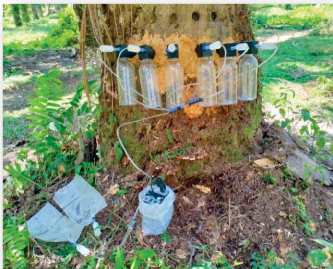
Gambar 1. Proses sampling E-nose pada batang sawit
